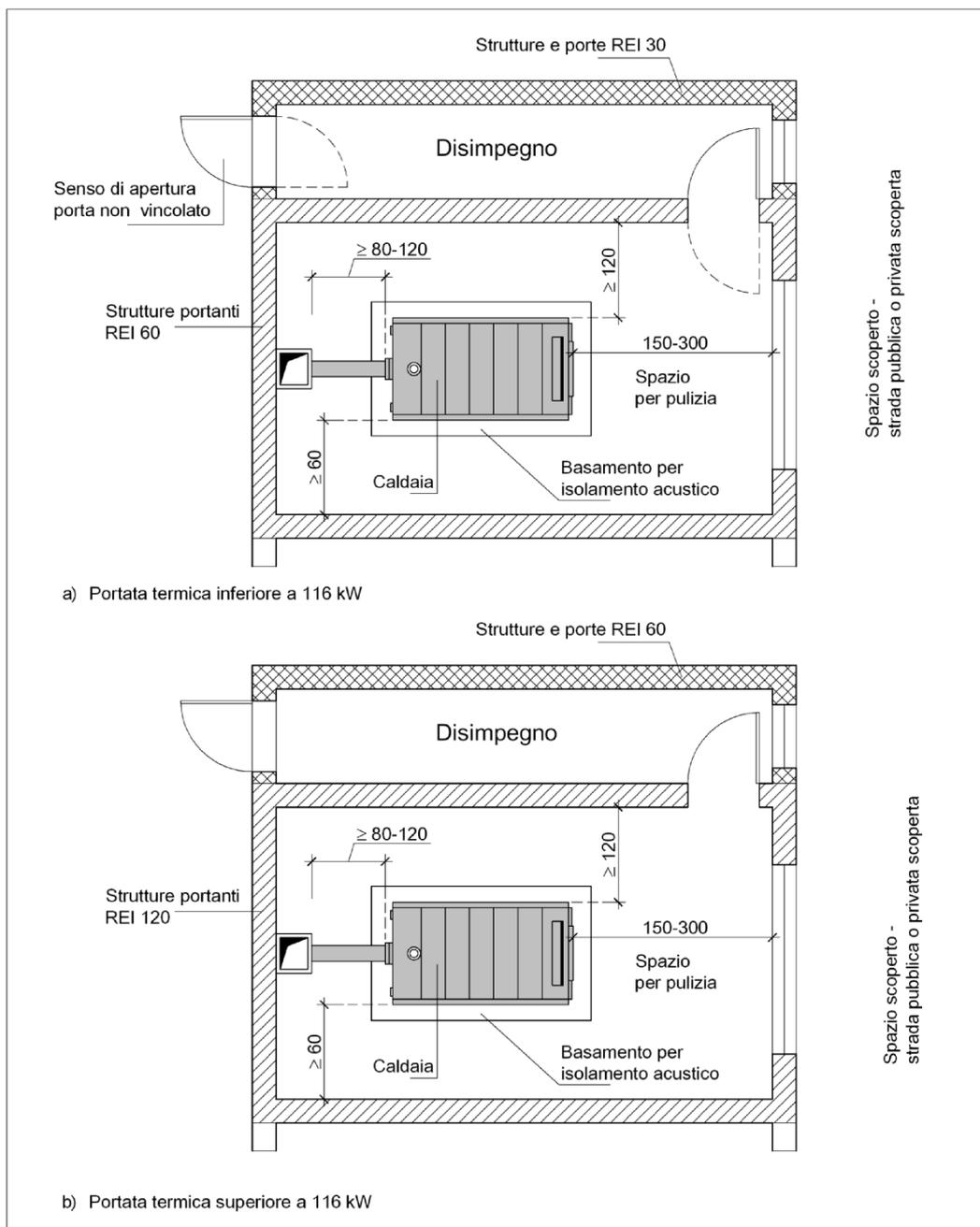
**Figura 81.10 - Esempio di centrale termica alimentata a gas di rete con accesso da disimpegno con parete attestata su spazio esterno o da strada pubblica o privata scoperta. Caratteristiche costruttive e distanze minime consigliate per gli spazi attorno al generatore**
