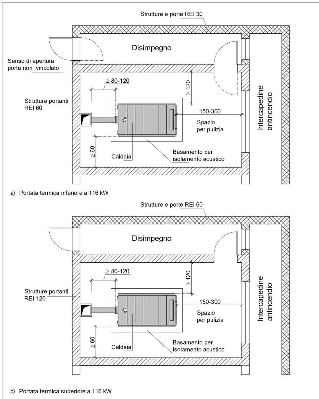
**Figura 81.9 - Esempio di centrale termica alimentata a gas di rete con accesso da disimpegno con parete attestata su intercapedine antincendio. Caratteristiche costruttive e distanze minime consigliate per gli spazi attorno al generatore**
