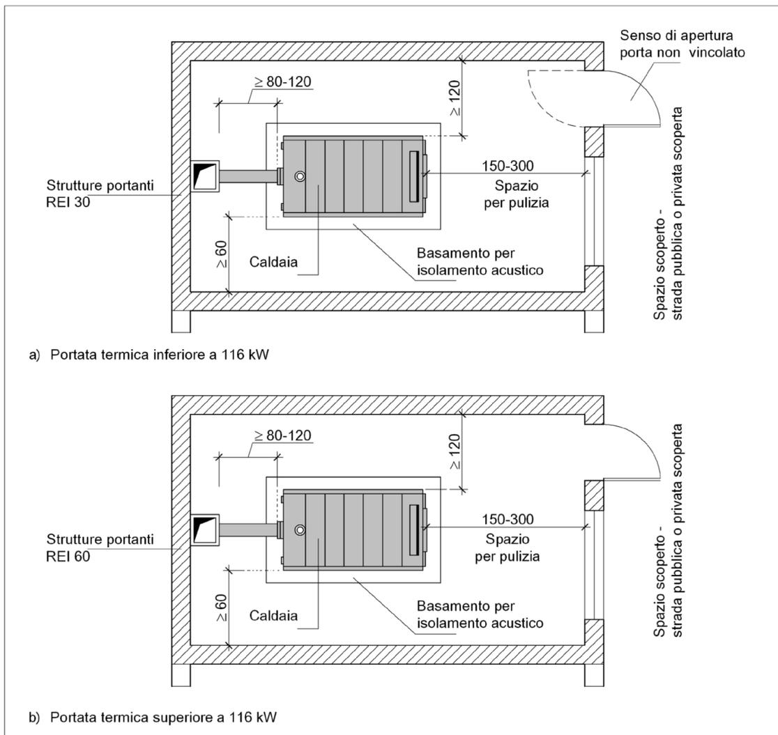
**Figura 81.7 - Esempio di centrale termica alimentata a gas di rete con accesso da spazio esterno o da strada pubblica o privata scoperta. Caratteristiche costruttive e distanze minime consigliate per gli spazi attorno al generatore**
