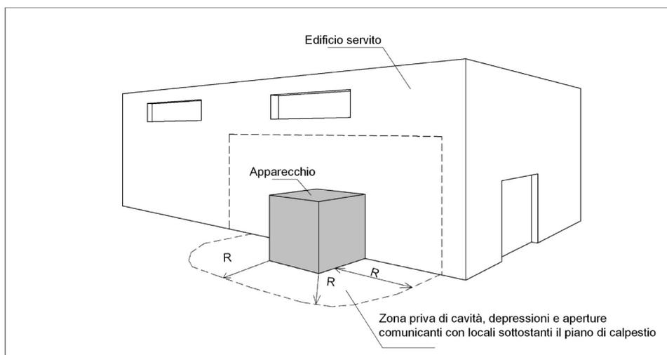
**Figura 81.3 - Distanze da rispettare per l'installazione all'aperto degli apparecchi alimentati con gas a densità maggiore di 0,8**
