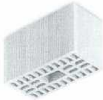
Figura 19.3 - Esempio di blocchi semipieni 15\% < \phi \leq 45\% in laterizio per murature portanti
