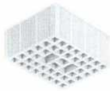
Figura 19.4 - Esempio di blocchi forati 45\% < \phi \leq 55\% in laterizio per murature portanti
