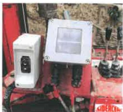
Figura 3.1.b: Display per il controllo della verticalità della perforazione
