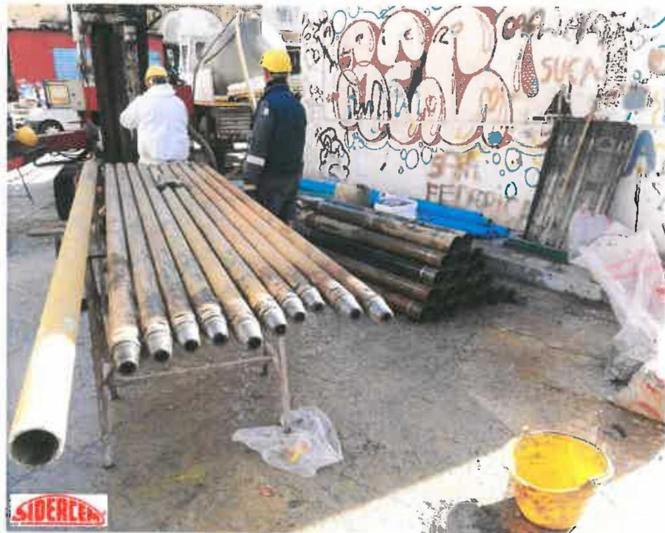
Figura 3.1.c: Batteria di aste e tubi di rivestimento
