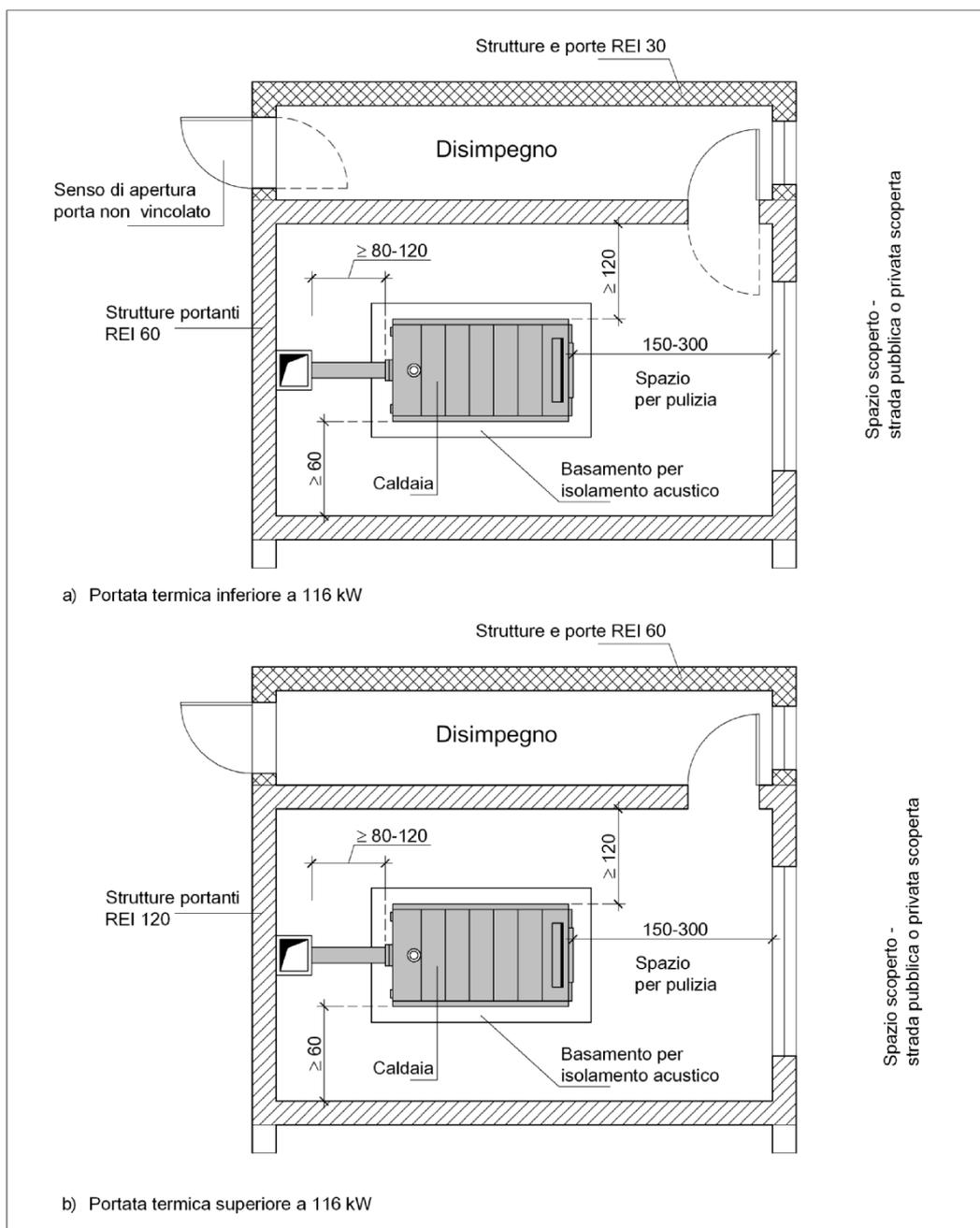
**Figura 81.10 - Esempio di centrale termica alimentata a gas di rete con accesso da disimpegno con parete attestata su spazio esterno o da strada pubblica o privata scoperta. Caratteristiche costruttive e distanze minime consigliate per gli spazi attorno al generatore**
