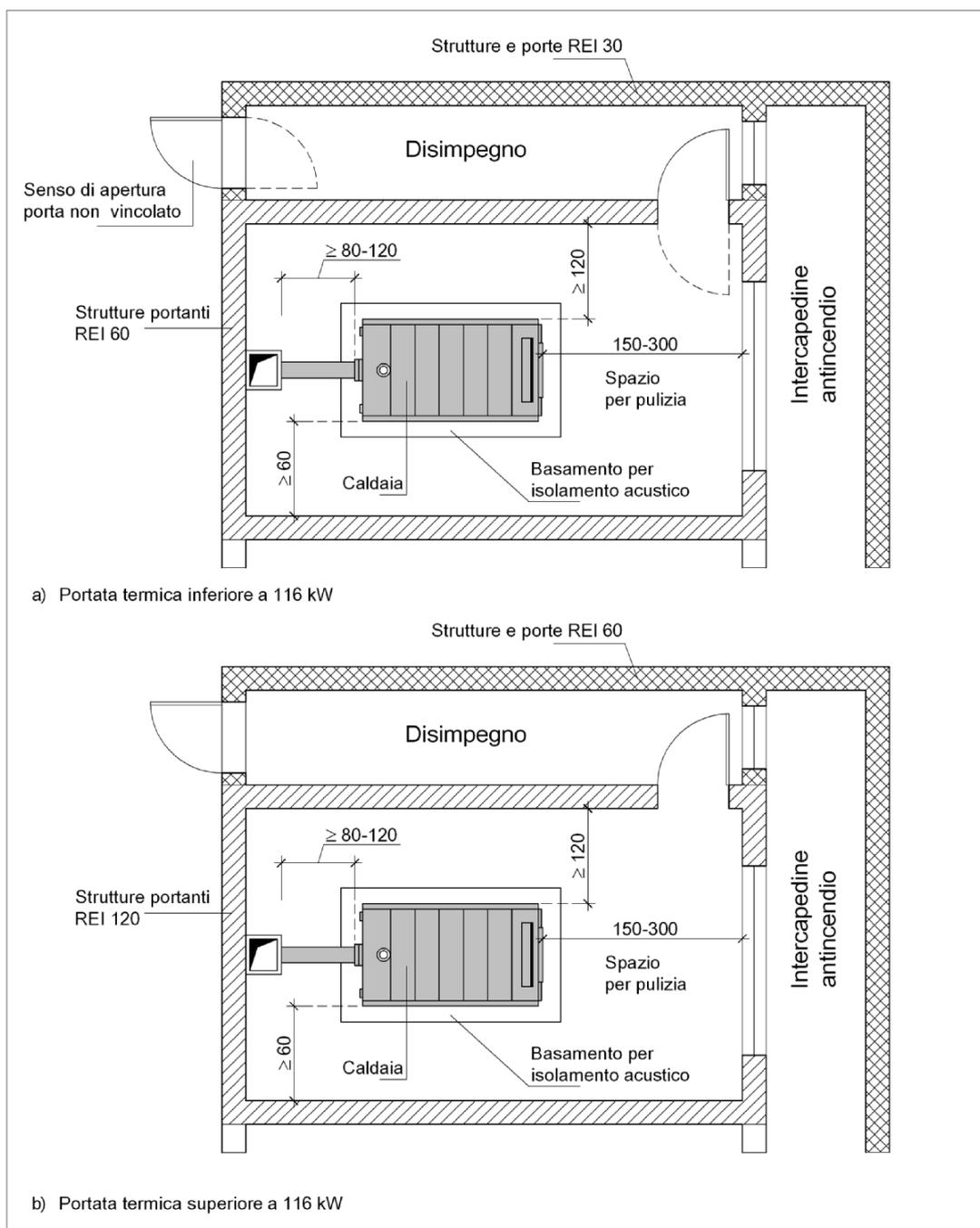
**Figura 81.9 - Esempio di centrale termica alimentata a gas di rete con accesso da disimpegno con parete attestata su intercapedine antincendio. Caratteristiche costruttive e distanze minime consigliate per gli spazi attorno al generatore**
