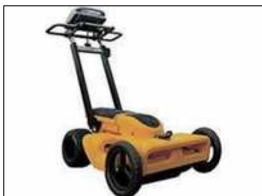
Le indagini georadar sono state effettuate utilizzando la strumentazione Georadar IDS OPERA DUO dotato di un modulo antenna a doppia frequenza; l'antenna ad alta frequenza (700 MHz) permette la localizzazione accurata di oggetti superficiali, l'antenna a bassa frequenza (250 MHz) consente la localizzazione di oggetti più profondi.
