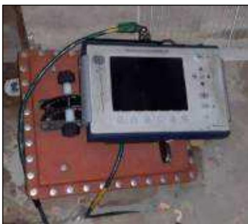
La strumentazione GEORADAR utilizzata per l'acquisizione dei dati sperimentali, consiste in un'unità centrale della GSSI – Geological Survey Sistem Inc. – modello SIR 3000 ed in antenna con frequenza centrale da 500 MHz.
